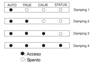
Se trascorrono tre secondi senza alcuna operazione, l'impostazione di damping è fissa e viene disattivata la modalità di controllo del damping.
